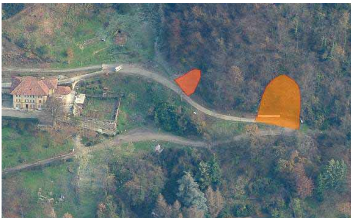
Frana che ha interrotto la strada privata ( a destra) a sinistra un fenomeno minore. Immagine di base da www.bing.com
