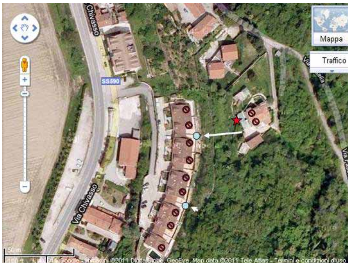
San Raffaele Cimena, località Via Chivasso 138 A. Fronte ( ● ) e traiettoria (freccia bianca) delle colate sviluppatesi a seguito dell'evento meteo-pluviometrico del 15-16 marzo 2011. Edifici sgomberati ( ⊘ ). Estensimetri installati dal Settore Protezione Civile ( ★ )
