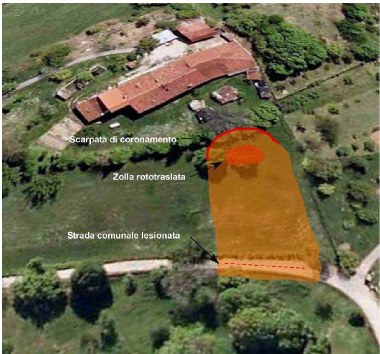
Pecetto Torinese via Ciattalina, schema del fenomeno franoso. Immagine di base da Earth Google. Vista da E verso O.
