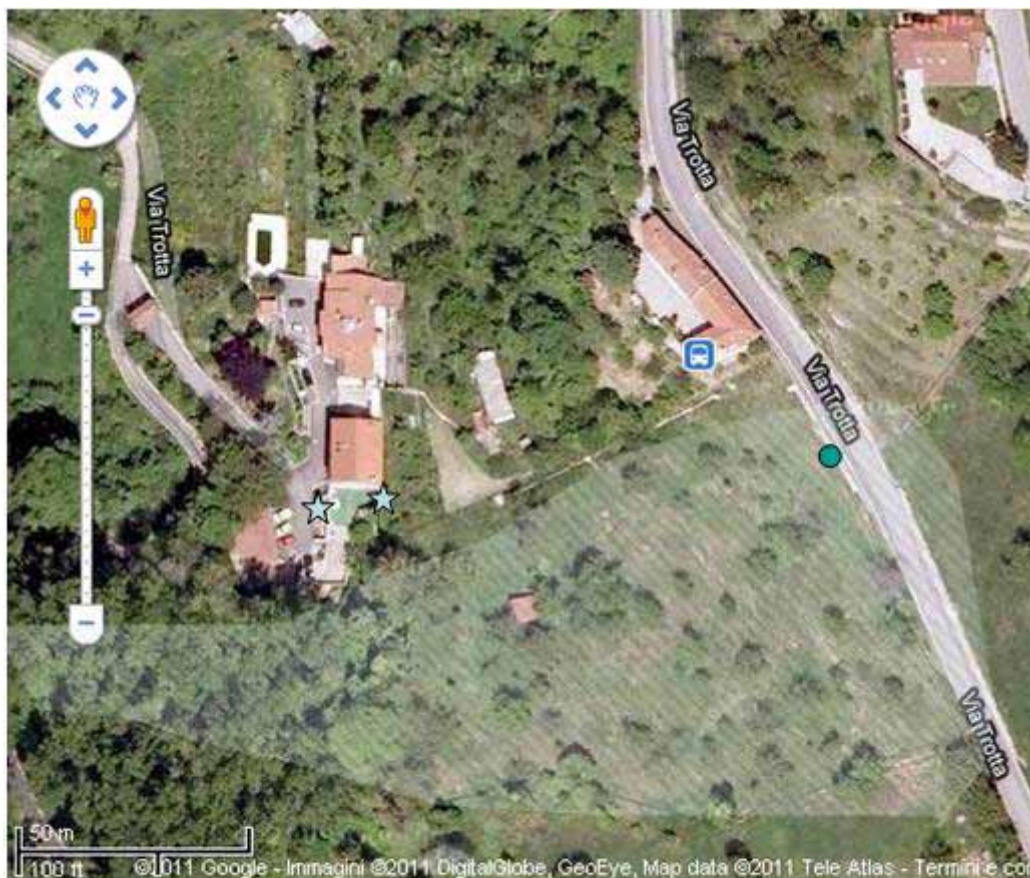
San Raffaele Cimena, località Via Trotta. Muri lesionati (★) a seguito dell'evento meteo-pluviometrico del 15-16 marzo 2011. Settore soggetto a colamento secondo studio geologico luglio 2010 del Comune (area retinata). Rotazionale di modeste dimensioni (●) sviluppatosi nell'ottobre 2000 (BDG Arpa P.).
