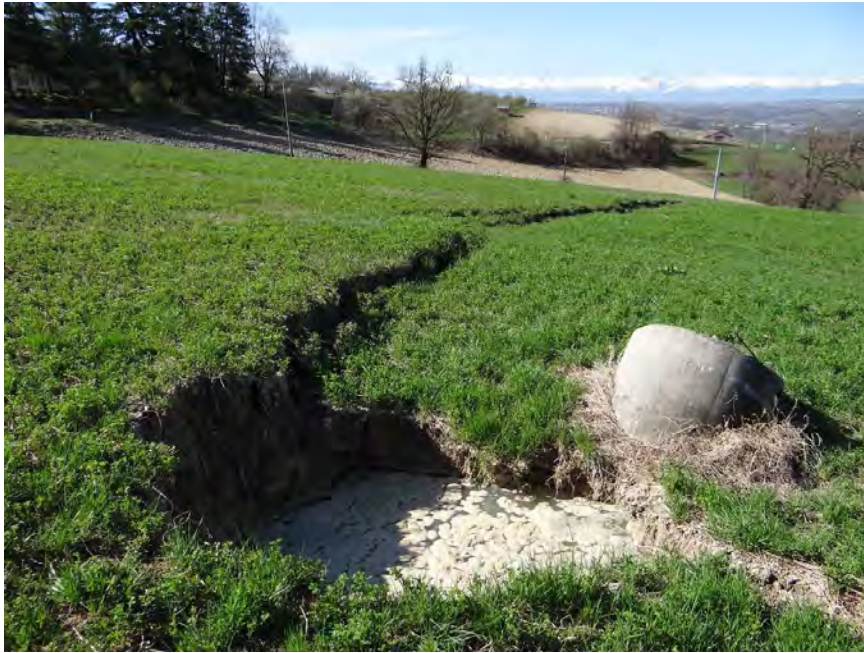
Immagine 03 - 2015/03/30-Settore sommitale del coronamento; poszzo distrutto e formazione di una cavità
