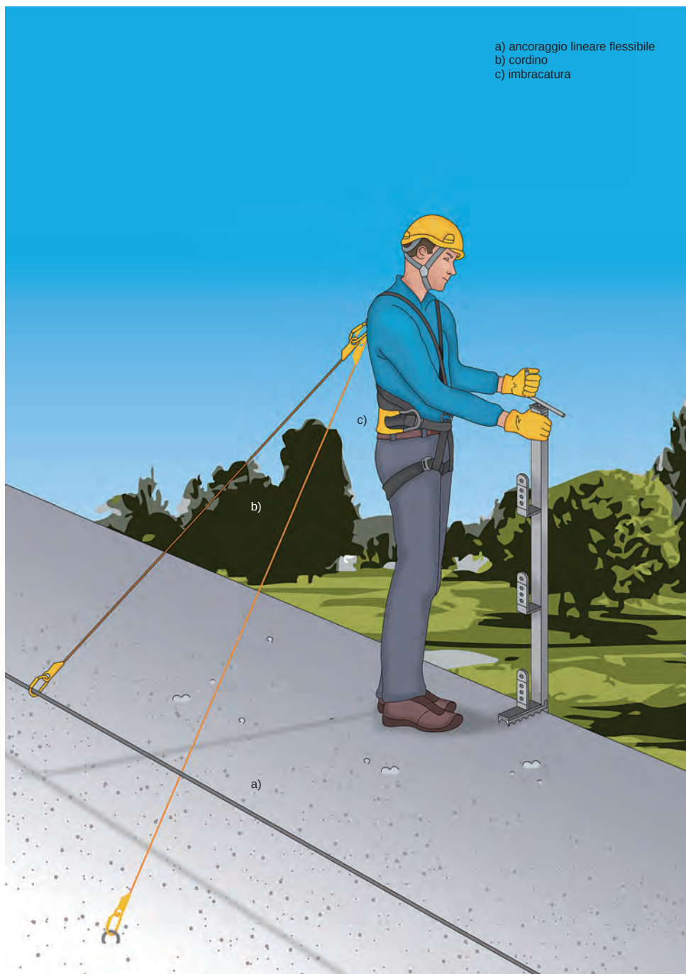
Figura 1 - Esempio di un sistema di trattenuta
