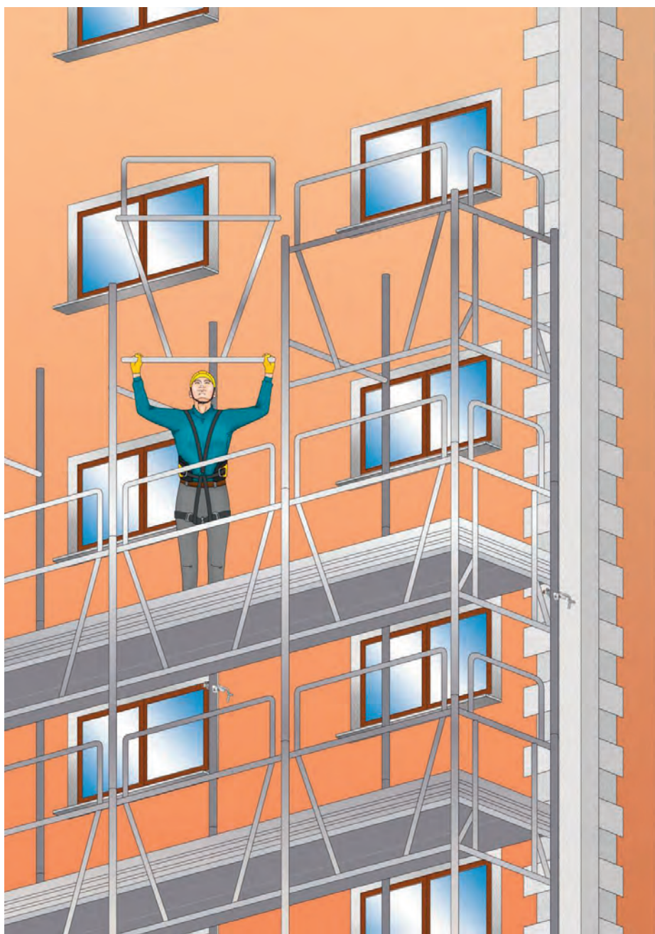
Figura 6 - Montaggio di un ponteggio con telaio parapetto (montaggio dal basso)
