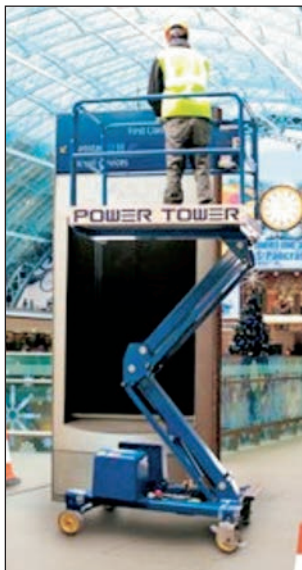
Piattaforma di lavoro mobile elevabile verticale (A1)
