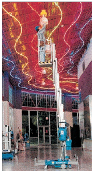
Piattaforma di lavoro mobile elevabile a colonna (A1)
