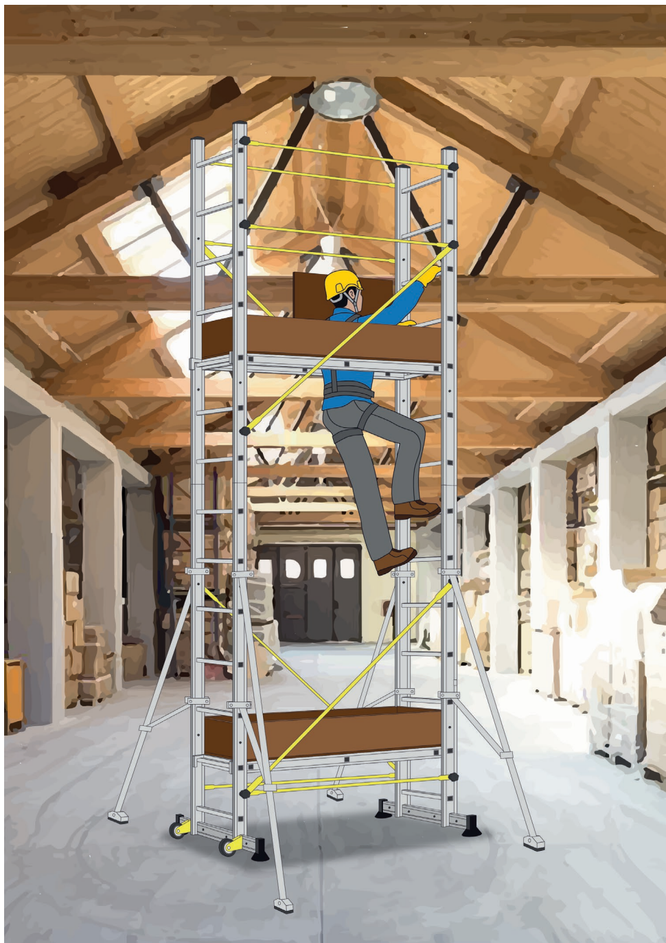
Figura 3 - Piccolo trabattello - Accesso dall'interno
