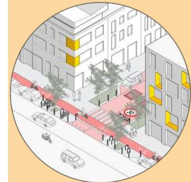
Utilizzo di misure strutturali, allargamento dei marciapiedi, restringimento della carreggiata, cambio del fondo e ampio uso di arredi o verde.
