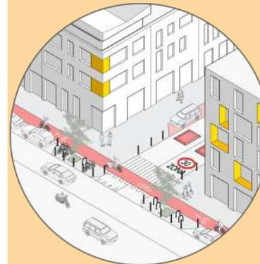
Utilizzo di misure strutturali, allargamento dei marciapiedi, restringimento della carreggiata e inserimento di elementi di arredo o verde.
