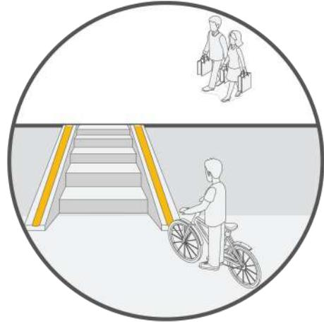
Accessibilità ciclistica sulle rampe di scale
