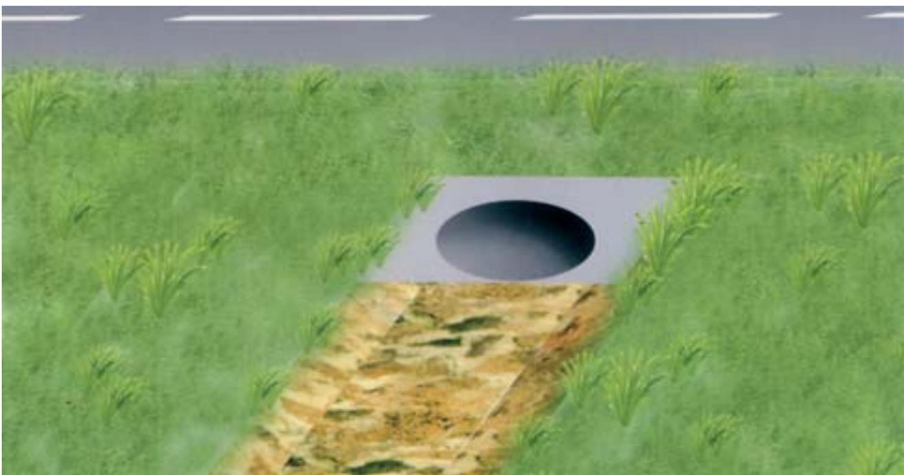
Fig. 19 - Sostituzione dei gradoni con un rivestimento in pietre che facilita l'accesso alle scarpate degli animali che utilizzano il drenaggio (tratto da Rosell, 1999)
