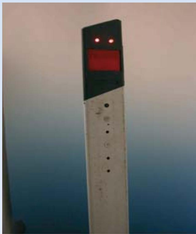
Fig. 9 - Dissuasore ottico sperimentale brevettato dall'Università di Bologna (Cecchi e Montoni, 2004). Quando il fascio di luce degli anabbaglianti colpisce il paracarro modificato, un sensore ottico attiva i led rossi verso i veicoli in transito e quelli gialli in direzione di animali selvatici eventualmente presenti al bordo della carreggiata.
