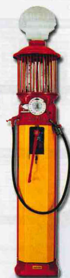
1634 Sasoni, Francia. Distribuzione a post-pagamento con dispositivo di inversione automatica.
