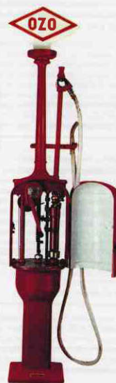
790-A, Gilbert & Baker, USA. Prodotto per il mercato europeo. Distributore in più punti vendita di 5 litri con dispositivo per misurare frazioni della capacità del cilindro.
