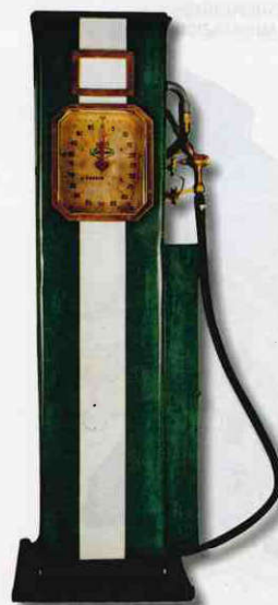
1938 Borgani, Italia. Distributore e misurazione volumetrica, indicatore a orologio.
