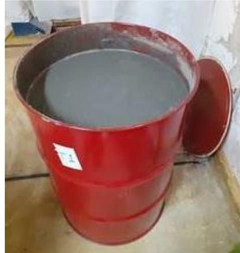
**Figura 2-109 – Fasi del trattamento di solidificazione dei rifiuti liquidi effettuato presso il sito di Bosco Marengo – Prodotti finali**
