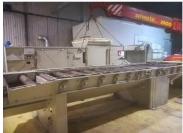
Figura 2-51 – Smontaggio macchina Pallinatrice
