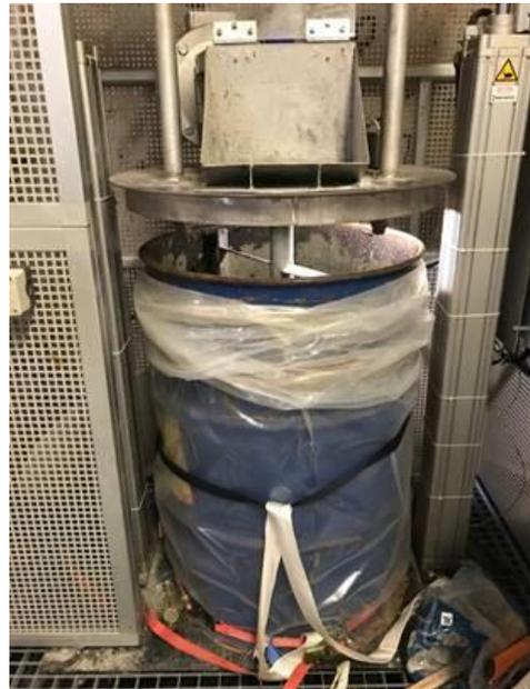
**Figura 2-107 – Fasi del trattamento di solidificazione dei rifiuti liquidi effettuato presso il sito di Bosco Marengo – Apparecchiatura e inserimento girante nel fusto**
