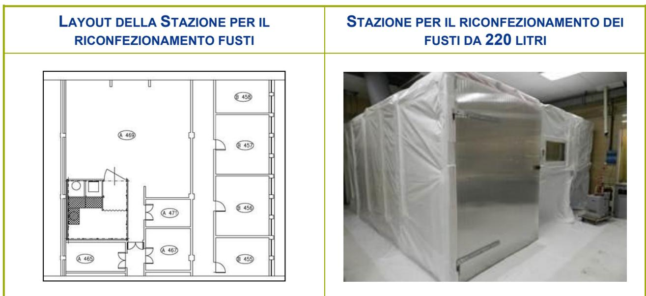
Figura 2-11 – Stazione per il riconfezionamento dei fusti di rifiuti con U-235 > 10 g
