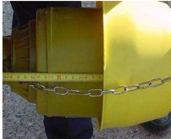
Quota minima di sovrapposizione (UNI EN ISO 4254-1)
