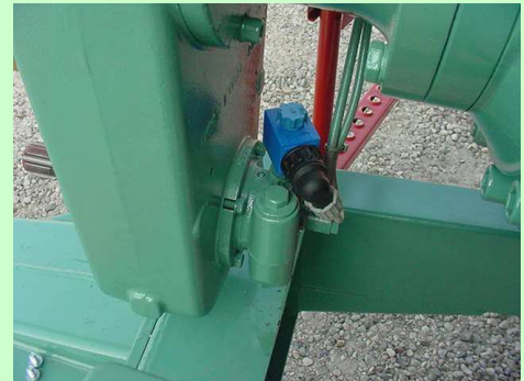
Esempio di dispositivo di disaccoppiamento
