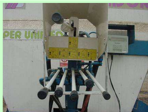
Esempio di comandi non accessibili dall'interno del cassone
