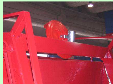
Esempio di specchio per garantire la visibilità indiretta sulla zona di lavoro posteriore
