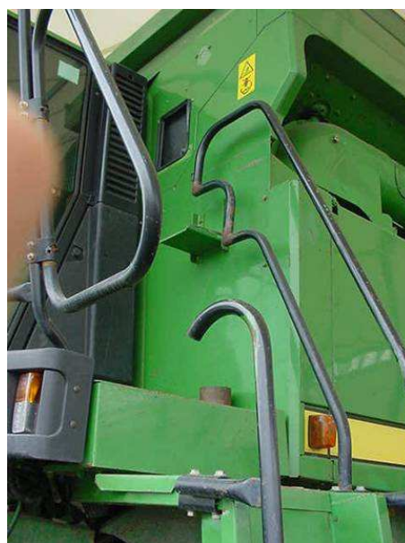
Esempi di scaletta con mancorrenti
