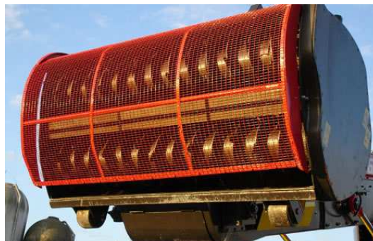
Adeguamento protezione fresa di macchina usata
