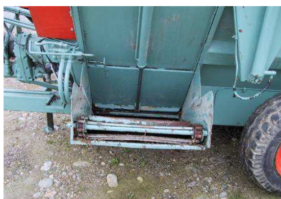
Esempio di tappeto di scarico non protetto
