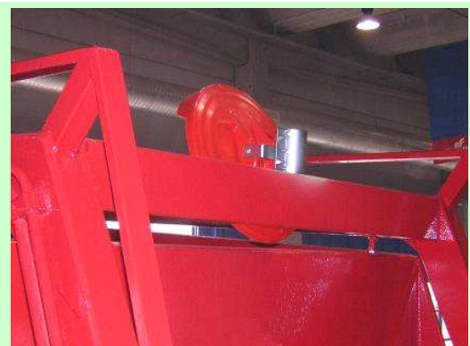
Esempio di specchio per garantire la visibilità indiretta
