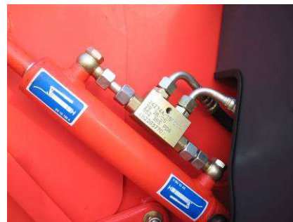
Esempio di valvola di blocco montata sul pistone di apertura testata di scarico
