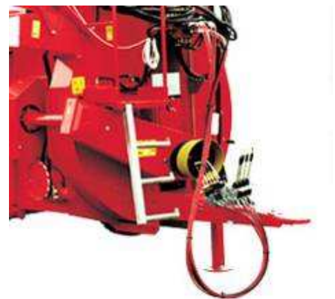
Esempio di scaletta di accesso
