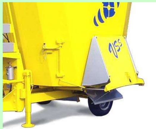
Esempio di scarico libero
