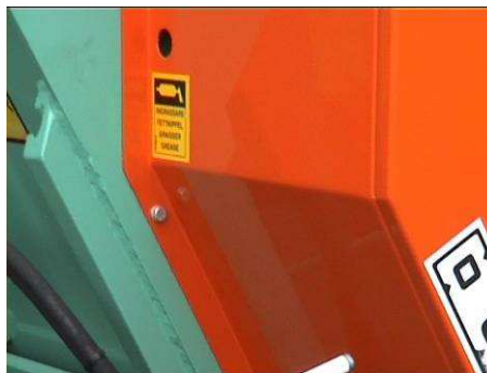
Esempio di trasmissione protetta con carter fisso
