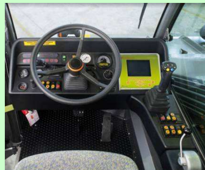
Esempio di comandi non accessibili dall'interno del cassone
