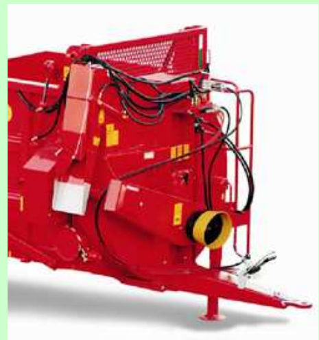
Esempio di scaletta di accesso
