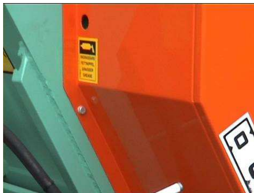
Es. di trasmissione protetta con carter fisso
