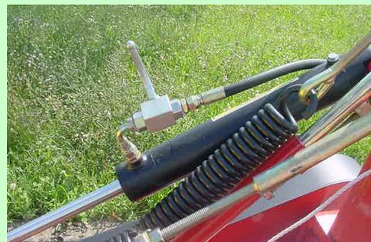
*Esempio di blocco idraulico*
