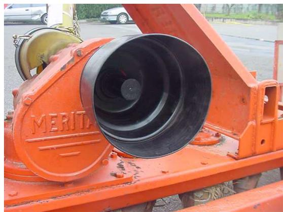
*Esempio di trasmissione cardanica adeguata*
