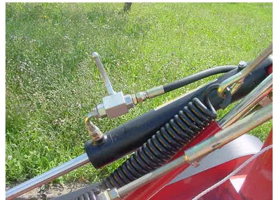
*Esempio di dispositivo di bloccaggio idraulico*
