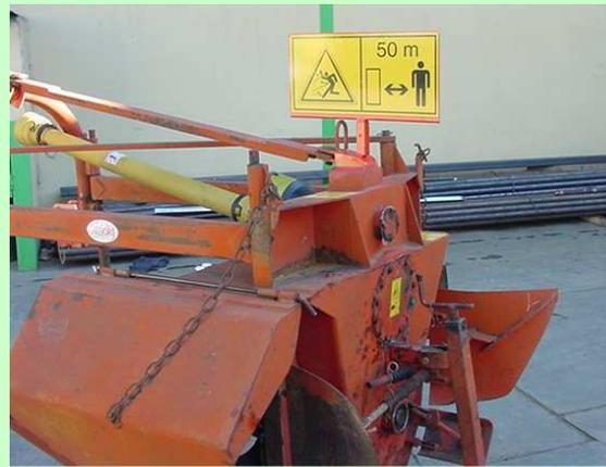
Di seguito, esempi di pittogrammi, desunti dalla norma ISO 11684 applicabili a macchina scavafossi.
