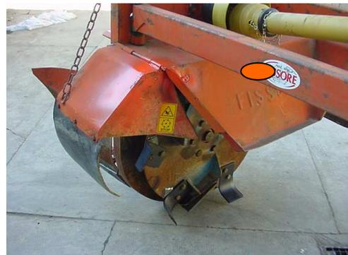
*Esempio di scavafossi con carter di protezione del rotore*
