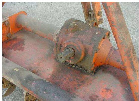
*Esempio di trasmissione cardanica
