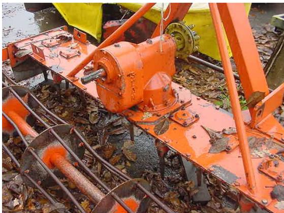
*Esempio di trasmissione cardanica non protetta*
