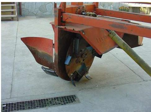
*Esempio di scavafossi con rotore non protetto*
