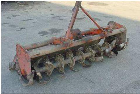
*Esempio di fresatrice agricola senza barriere*
