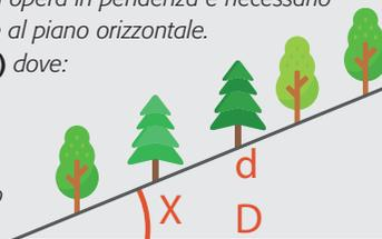
In alternativa è possibile utilizzare la semplice tabella riportata sotto che contiene i coefficienti da moltiplicare per trasformare la distanza misurata sul terreno inclinato in distanza sul piano orizzontale.
