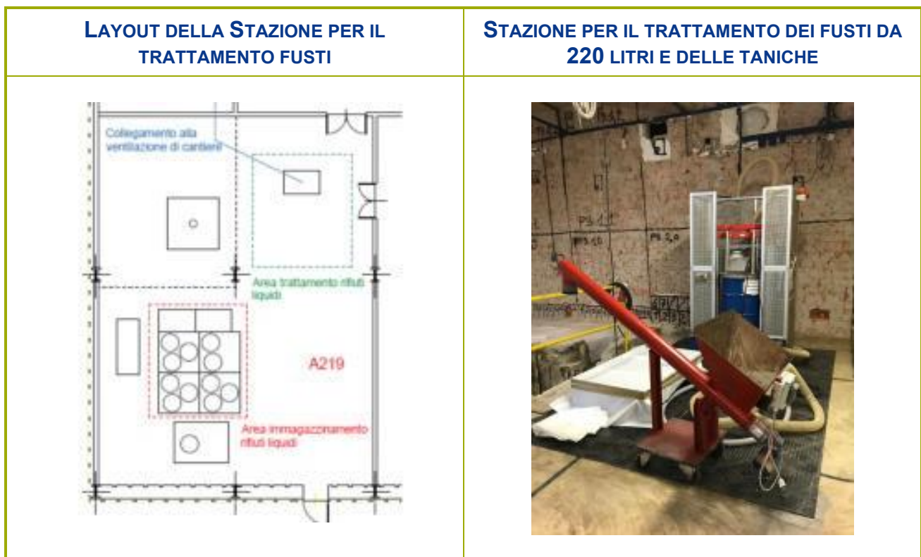
Figura 2-12 – Stazione per il trattamento dei fusti e taniche contenenti rifiuti radioattivi liquidi
