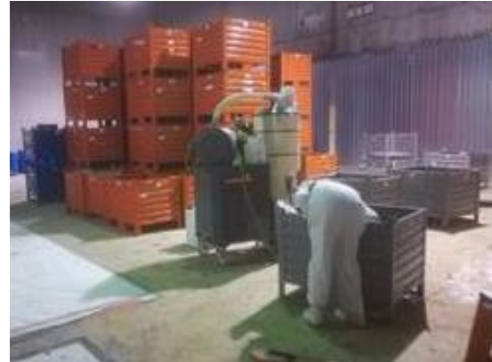
Figura 2-50 – Decontaminazione ad umido dei cassoni
