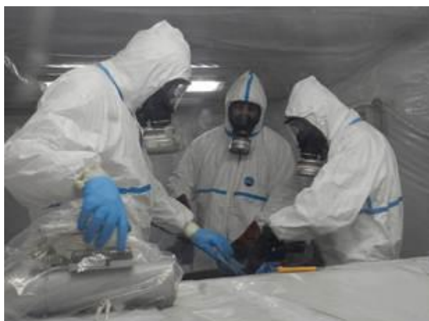
Apertura del fusto con U-235 > 10 g
