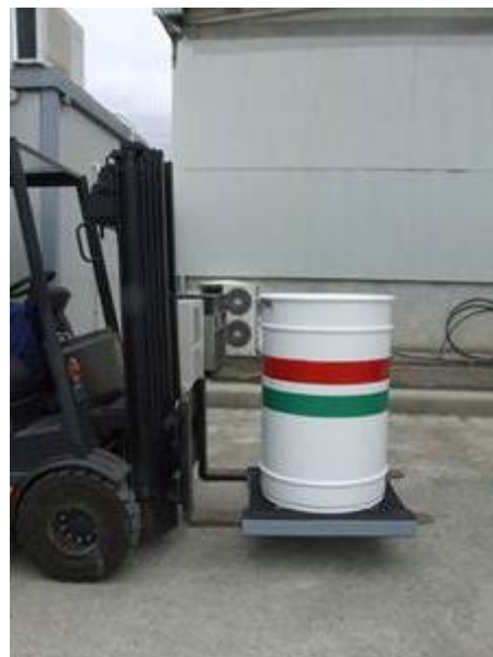
Spostamento dell'overpack alla stazione di misura
