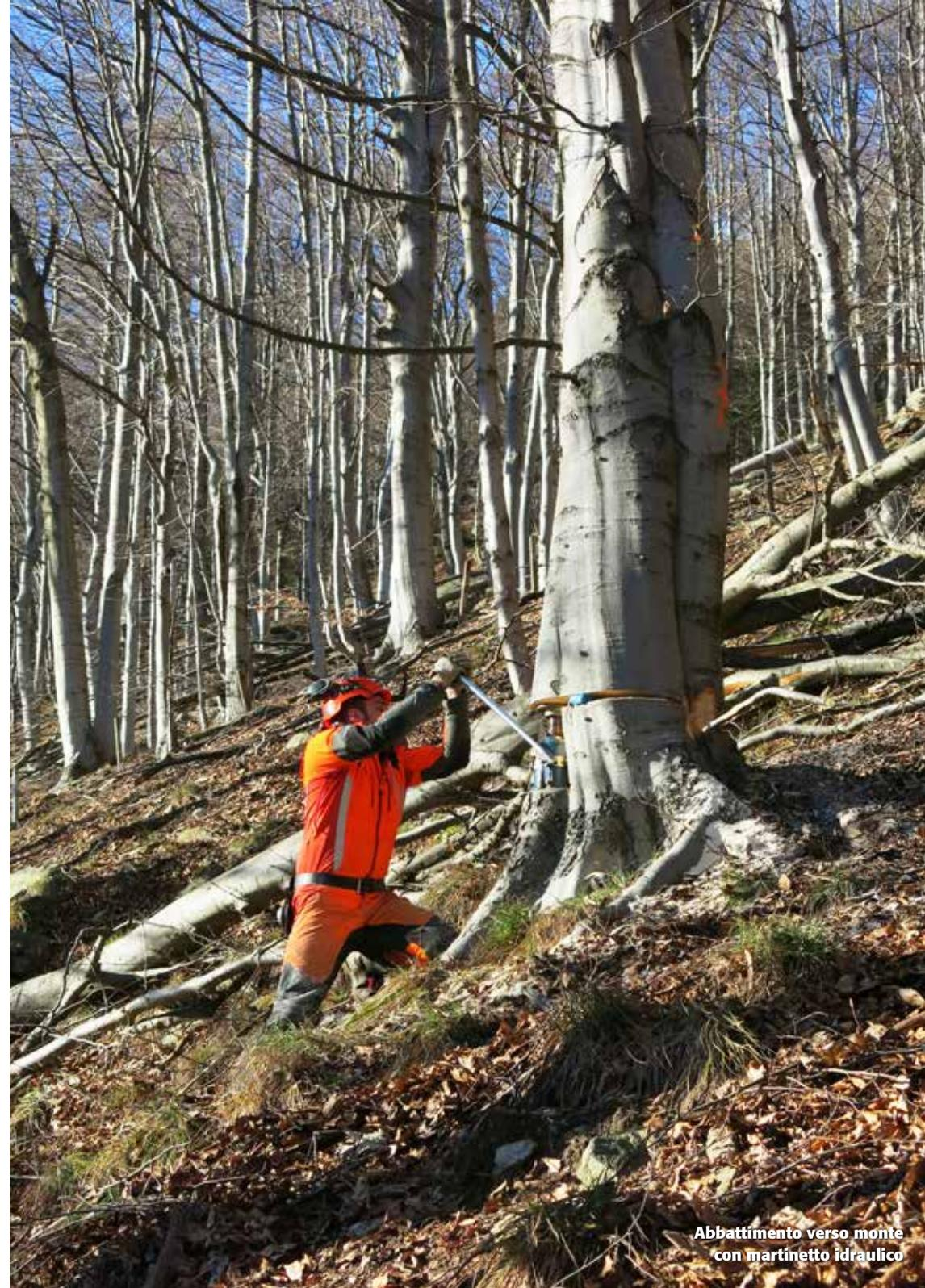
Abbattimento verso monte con martinetto idraulico
