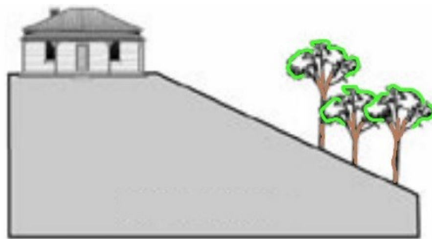
Pendenza elevata -> ampiezza zona di intervento superiore
