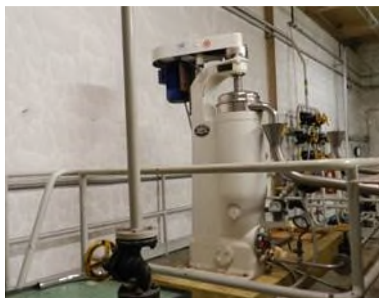
Figura 2-34 – Smantellamento delle supercentrifughe
