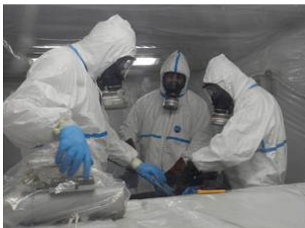
Apertura del fusto con U-235 > 10 g
