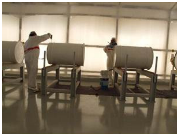
Verniciatura dell'overpack
