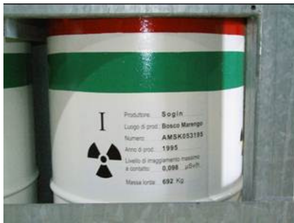
Marcatura tramite applicazione di etichetta adesiva
