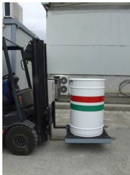
Spostamento dell'overpack alla stazione di misura
