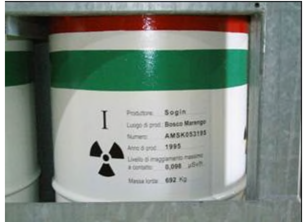
Marcatura tramite applicazione di etichetta adesiva
