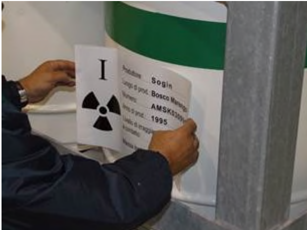
Marcatura tramite applicazione di etichetta adesiva
