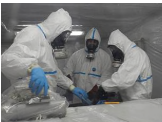
Apertura del fusto con U-235 > 10 g
