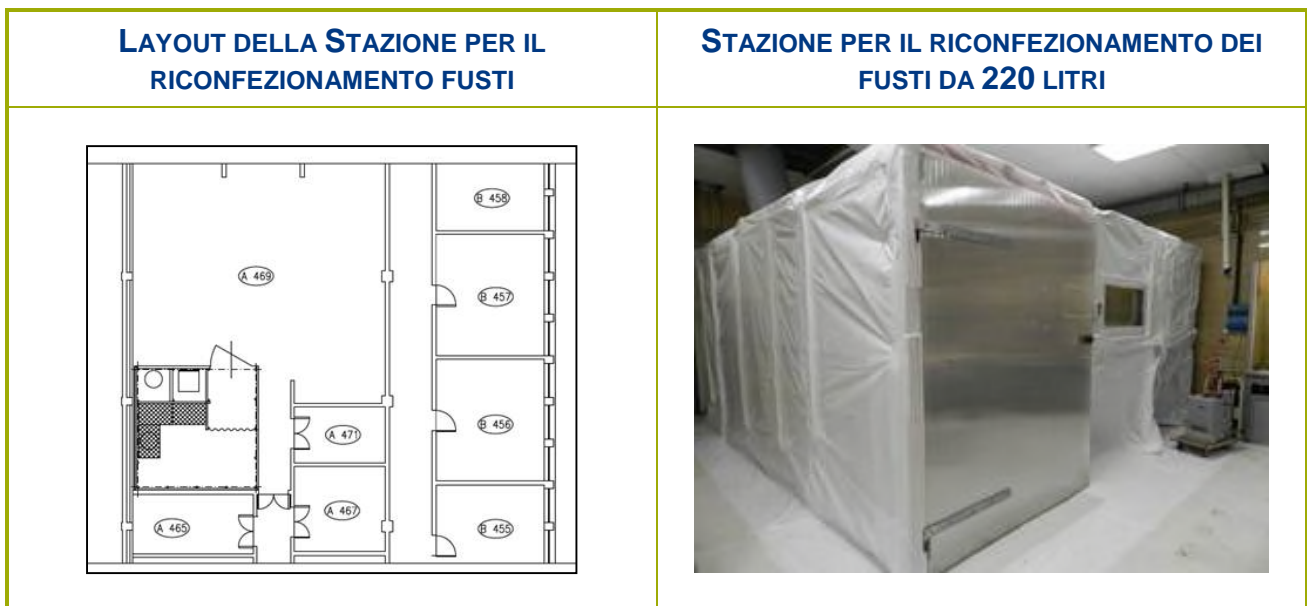
Figura 2-10 – Stazione per il riconfezionamento dei fusti di rifiuti con U-235 > 10 g
