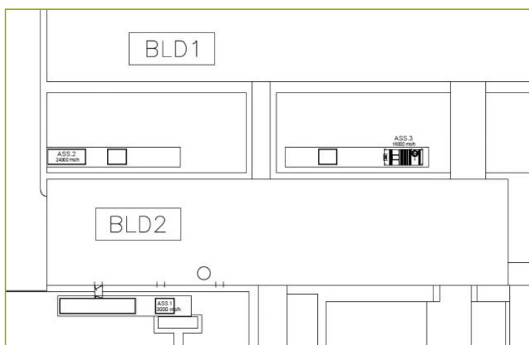
Figura 2-12 – Sistema di ventilazione di cantiere: posizionamento UTA e gruppi di filtrazione assoluta
