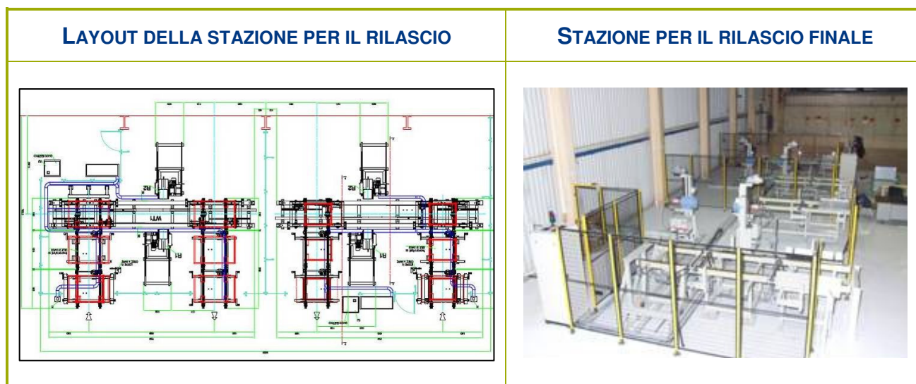
Figura 2-5 – Stazione per il rilascio finale dei materiali smantellati
