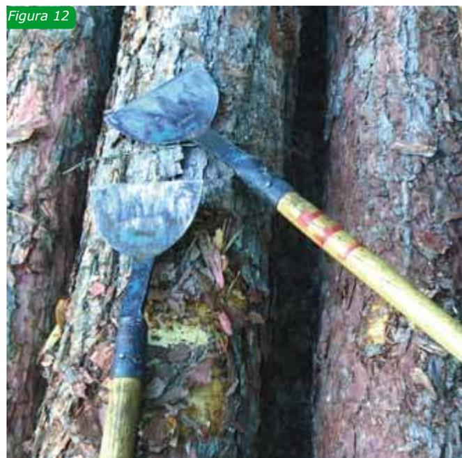
Fig. 12: lama per scortecciatura manuale
