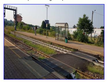
A fronte del sopralluogo effettuato si è constatato innanzitutto che collegamento pedonale tra le banchine avviene mediante а raso. l'attraversamento dei binari 1 e 2, nell'assenza totale di qualsiasi tipo di informazione (segnaletica e/o avvisi dedicati anche acustici), la stazione ferroviaria è una di quelle impresenziate, infatti come suddetto l'impianto ferroviario è telecomandato a distanza.
