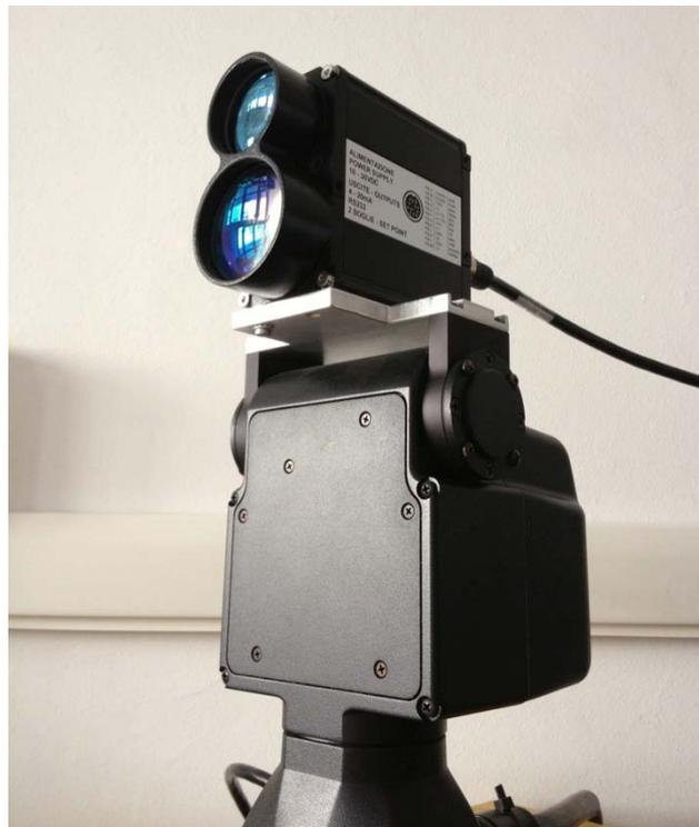
Figura 3. Prototipo del sistema di monitoraggio laser sviluppato nel progetto.
