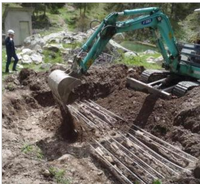
Figure 8. Illustration du dispositif expérimental de Castérino lors du déterrage des échantillons de racines ligneuses après 4 ans de décomposition – (photo : Bambara G., 2013)
