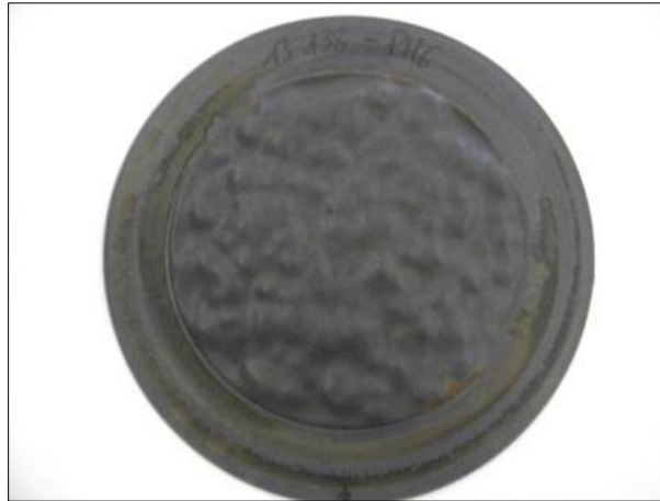
Figure 35 - Déformations observées sur la géomembrane protégée par le géotextile C vis-à-vis des sollicitations de poinçonnement.
