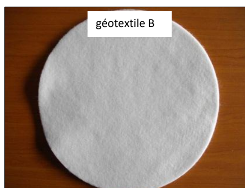
Figure 32 - Illustration d'un géotextile non-tissé aiguilleté en fibres polypropylène vierges pour la fonction protection
