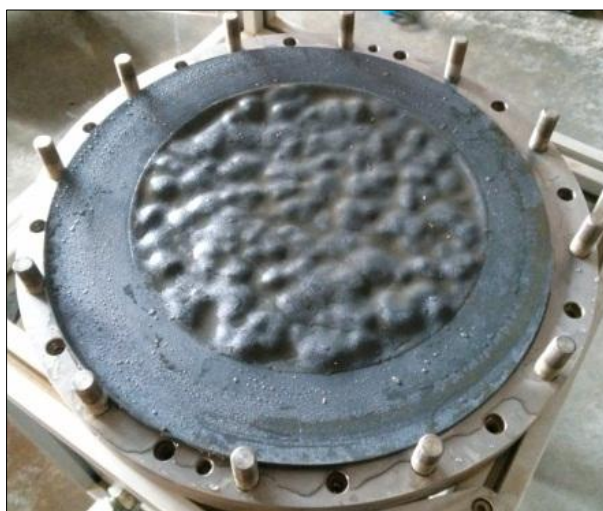
Figure 34 - Déformations observées sur la géomembrane protégée par le géotextile A vis-à-vis des sollicitations de poinçonnement.
