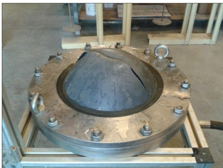
Figure 31 - Exemple d'une éprouvette de géomembrane à la fin d'un essai d'éclatement selon la norme NF EN 14151
