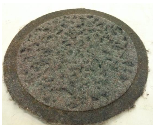
Figure 29 - Exemple d'un géotextile de protection (vue de la face en contact avec les granulats) qui a subi des sollicitations de poinçonnement
