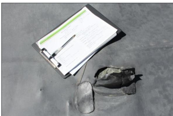
Figure 38 – Poinçonnement (pointé par une flèche) et perforation de la géomembrane par un bloc anguleux de taille importante
