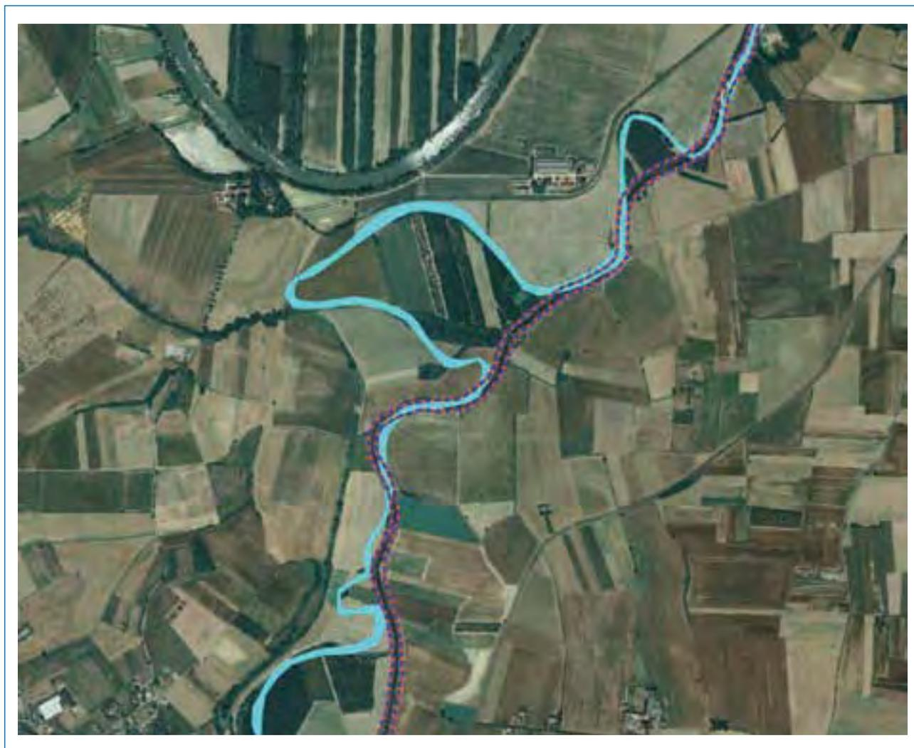
L'immagine riporta in azzurro l'alveo del torrente Belbo prima dell'inalveamento (linea tratteggiata) eseguito dopo la piena del novembre 1968 attraverso la ricalibratura della sezione dell'alveo, la difesa delle sponde e il taglio di alcuni meandri. L'analisi delle pressioni sulla naturalità dell'alveo, basata sul riconoscimento delle opere da fotointerpretazione, non ha permesso di rilevarne l'artificialità riconoscibile solo mediante la visione delle immagini aeree del 1978.
