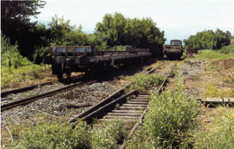
Carri adibiti al recupero di rotaie e traversine (1998)
