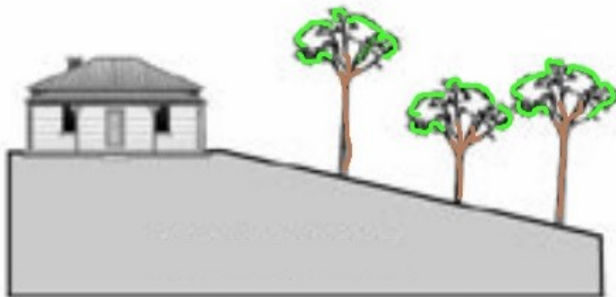
Pendenza ridotta -> ampiezza zona di intervento inferiore
