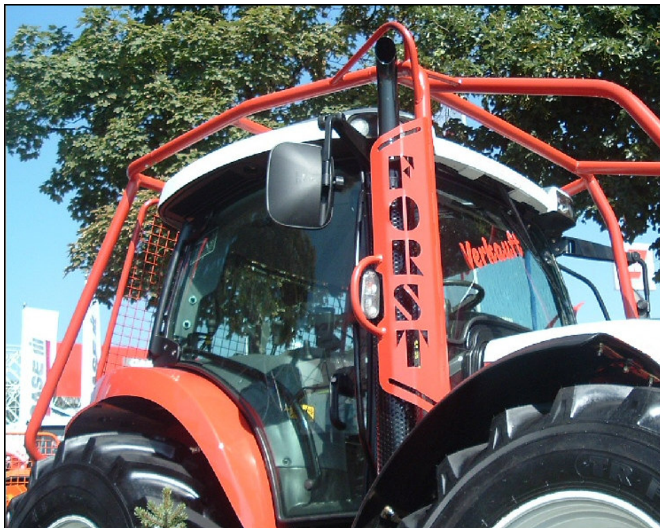
Esempio di griglia di protezione del silenziatore
