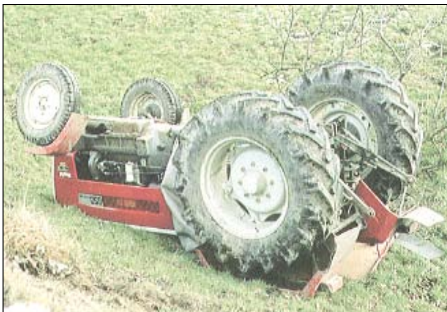
Ribaltamento di trattore non dotata di ROPS
