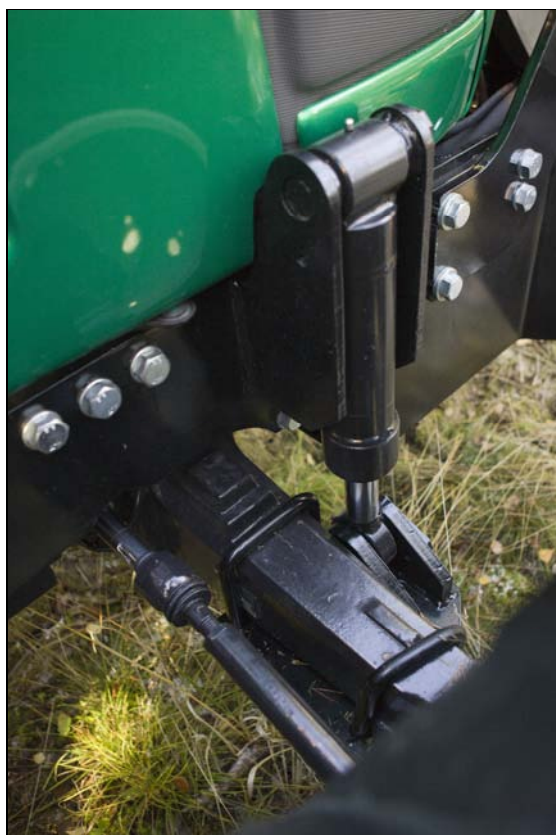
Esempio di sistema di stabilizzazione dell'assale anteriore
