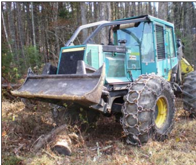
Esempio di lama livellatrice anteriore
