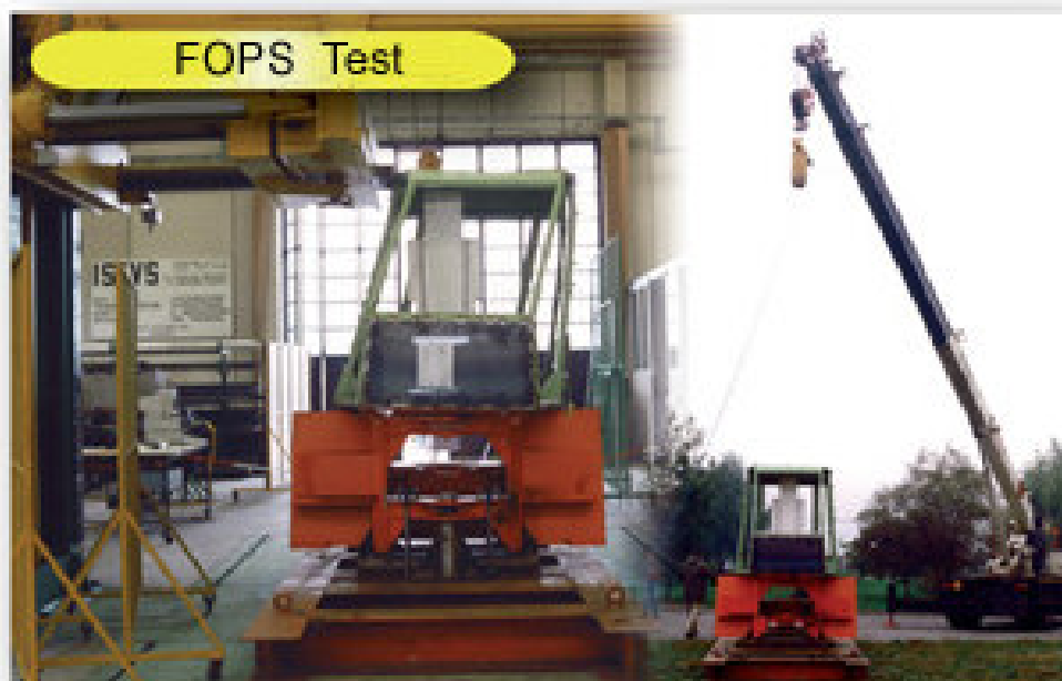
Esempio di prova FOPS
