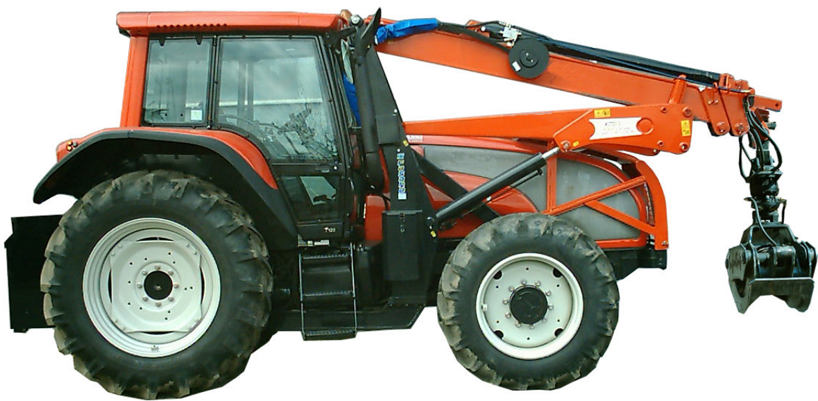
Esempio di caricatore frontale con pinza idraulica
