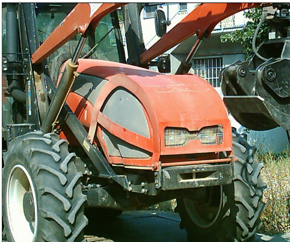
Esempio di protezione laterale
