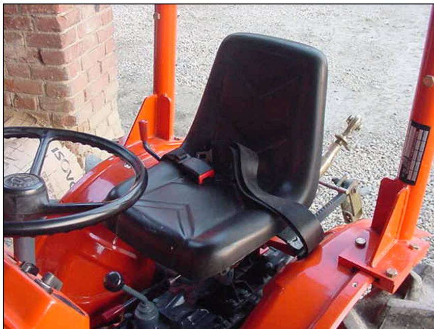
Esempio di cintura di sicurezza installata su macchina usata
