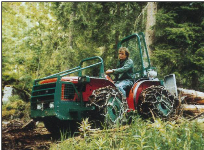
Esempio di catene montate su trattore forestale
