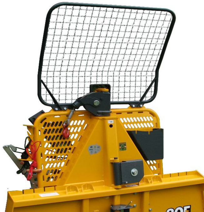
Esempio di griglia di protezione di un verricello forestale
