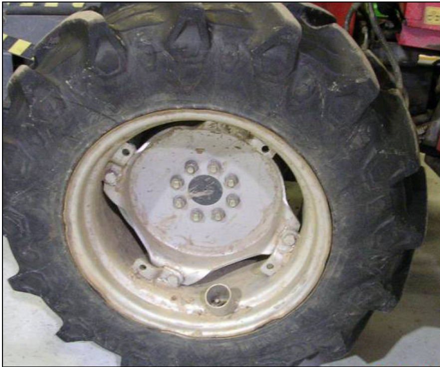
Esempio di protezione della valvola di gonfiaggio
