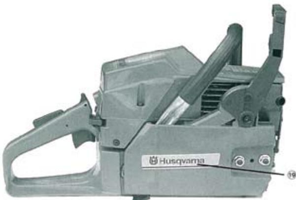
Ovo kućište fiksira vodilicu, pokriva lančanik i kvačilo, štiti operatera od nesrećnih slučajeva, a tokom odsecanja granja služi kao površina koja klizi duž oborenoga debla.
