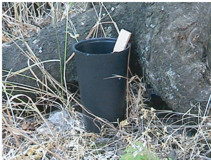
Ovitrapola per il monitoraggio di zanzara tigre.
