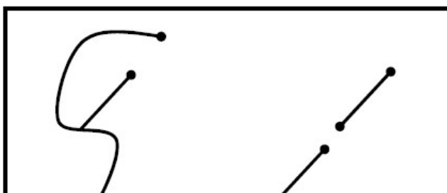
Geometrie lineari non corrette: a) manca un nodo all'intersezione delle due linee; b) non sono ammesse geometrie multiple; c) non sono ammesse sovrapposizioni
