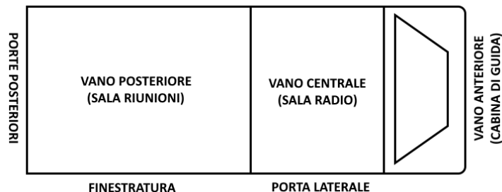
Figura 6 – Schema indicativo (non in scala) delle zone funzionali del mezzo UMCT
