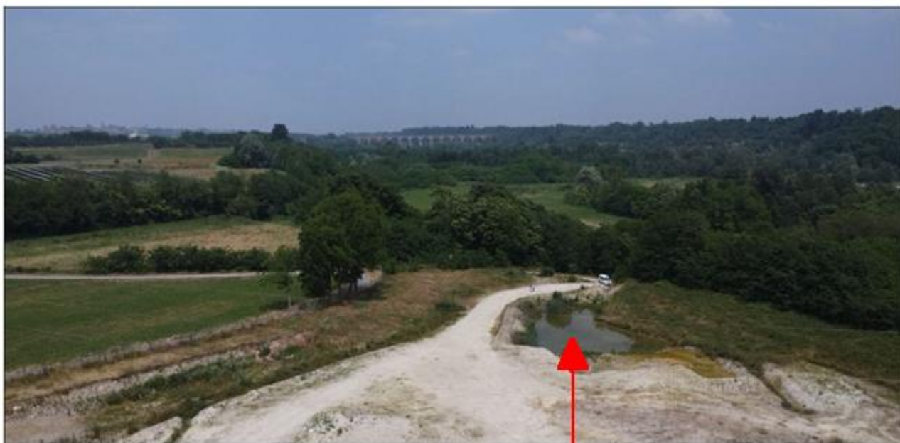
Foto 6– Dettaglio della futura zona 2 - recupero naturalistico ad area umida e formazioni ripariali in fase iniziale, al momento l'invaso assolve il ruolo di vasca di decantazione . Nell'ultima fase di coltivazione l'area 2 verrà completata come previsto da progetto
