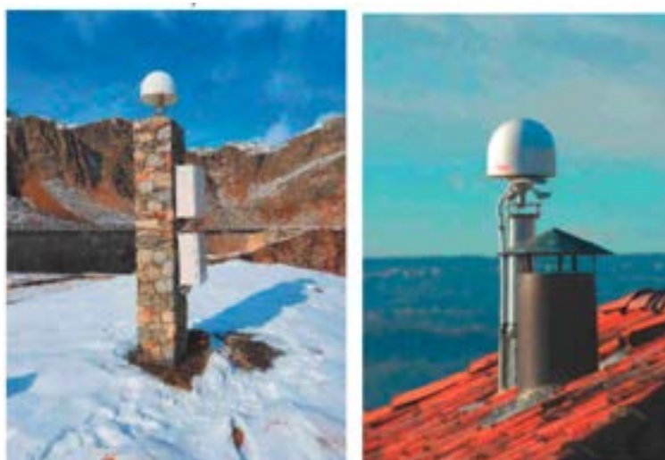
Figura 2 - Esempi di monumentazione di antenne geodetiche - Lago Agnel (AGNE), Biella (BIEL)
