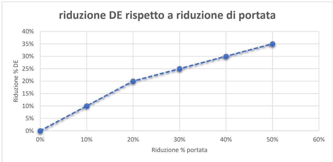
**Figura 7-1: riduzione del DE rispetto alla riduzione di portata per valori superiori a 11,1 m<sup>3</sup>/s**
