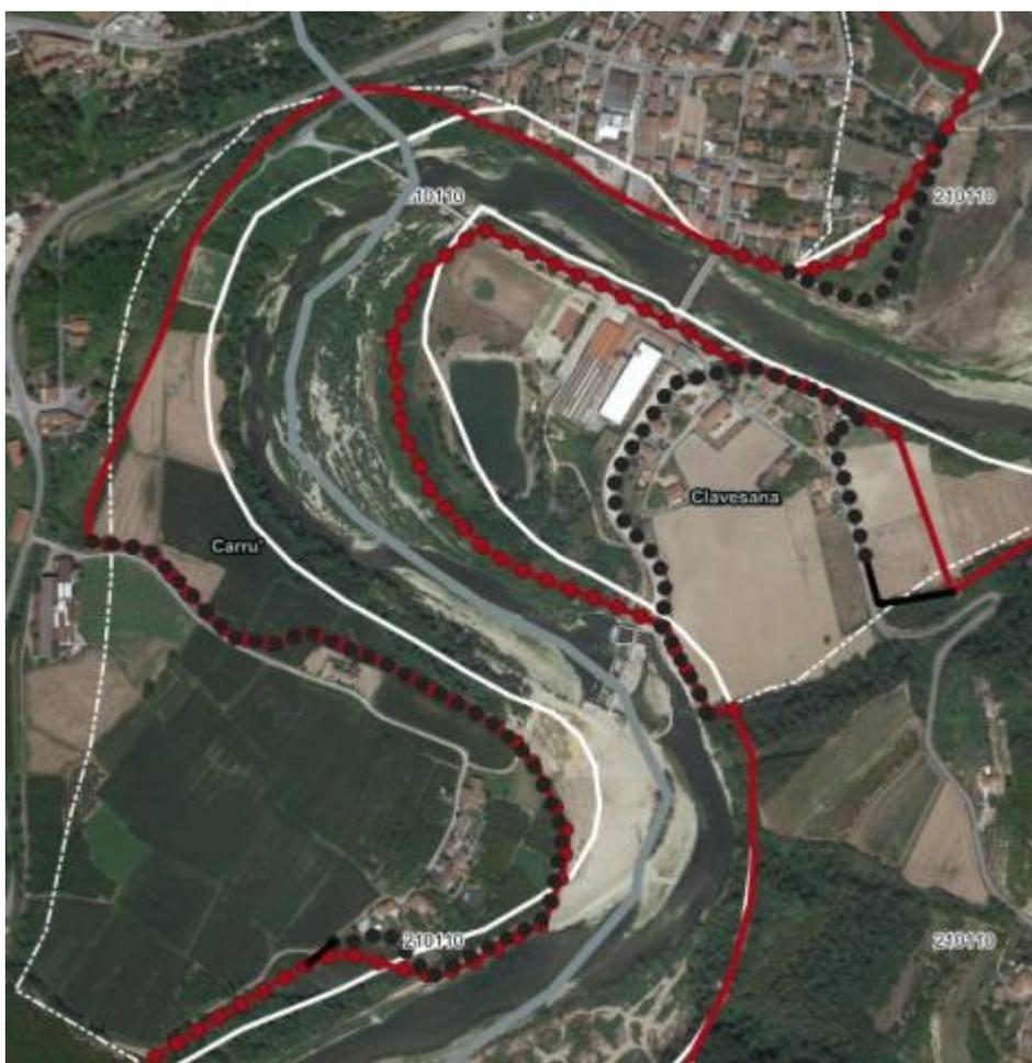
Assetto di progetto tra Carrù e Clavesana: in rosso i limiti del Progetto di Variante, in nero la proposta di AIPo a seguito del modello finalizzato a definire gli interventi per la mitigazione del rischio
