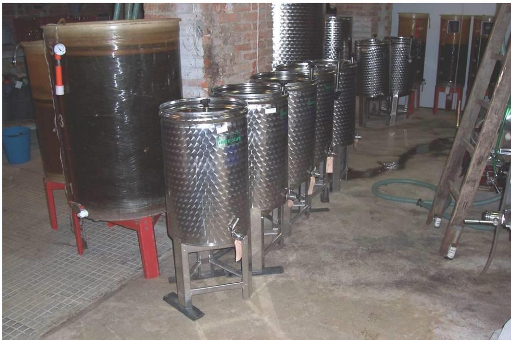
Esempio di batteria di vaschette in acciaio per microvinificazioni
