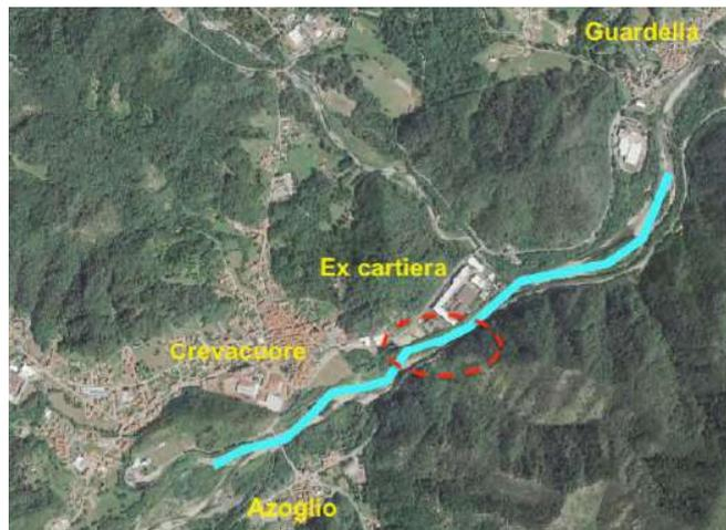
Il tratto in forte pregiudizio di stabilità si limita a circa 60 m (cfr. Planimetria di progetto - tratto da sez. 7 a sez. 12 circa) ma la scarpata potenzialmente ancora a rischio di erosione e franamento se non adeguatamente protetta ha uno sviluppo di circa 110 m.
