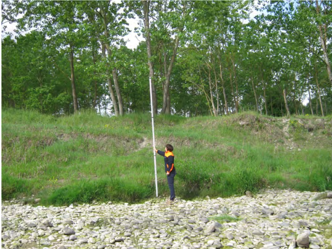
FOTO 7 – Misura altezza sponda destra canale Sud
