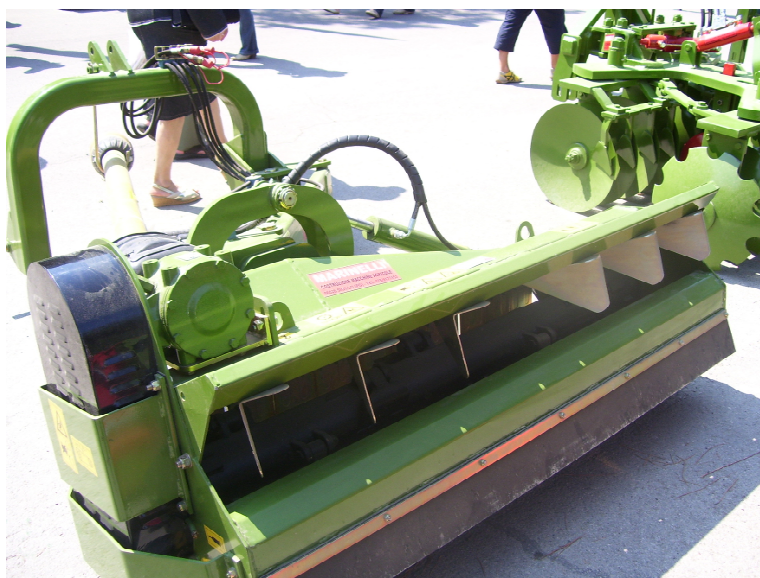
Fig. 15 – Esempio di macchina con portellone superiore apribile e dotata di deflettori
