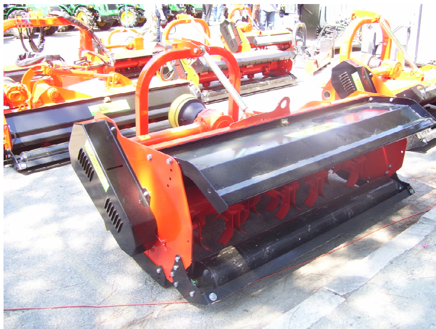
Fig. 16 – Esempio di macchina con portellone superiore apribile ed incernierato superiormente
