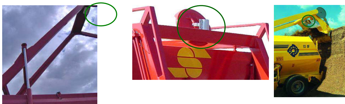
Figura 6. Esempi applicativi di specchi (evidenziati in figura) installati sulla struttura portante dei bracci dell'organo di taglio (fresa).
