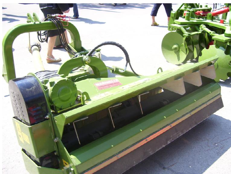
**Fig. 15 – Esempio di macchina con portellone superiore apribile e dotata di deflettori**
