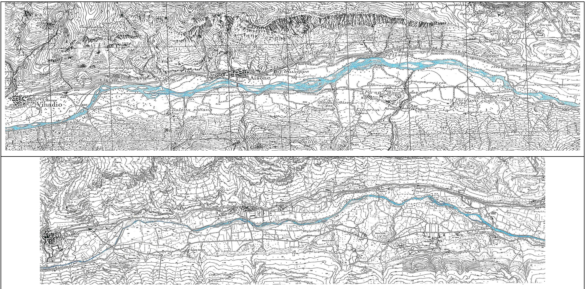
Figura 7 - Confronto tra l'alveo dello Stura nel tratto Vinadio-Aisone come riportato sulla cartografia IGM del 1933 e dalla Carta tecnica Regionale della Regione Piemonte 1991
