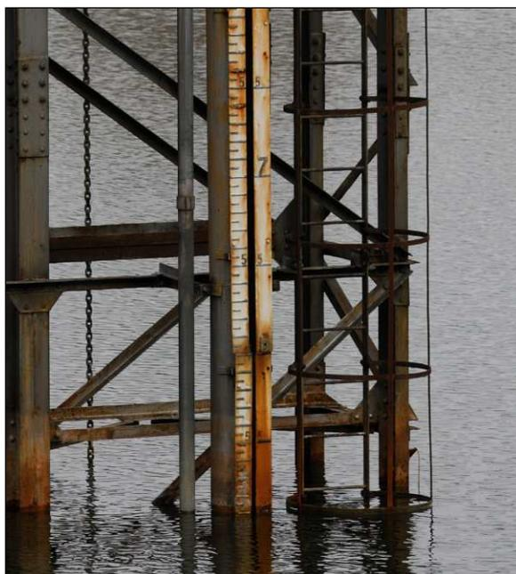
Figura 3 - Asta idrometrica posta in mezzo al Lago di Bertignano – Misurazione del mese di luglio 2007; livello : 2,70 m
