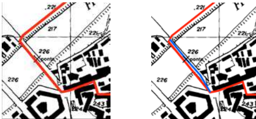
Traccia rilevata con GPS in rosso e punto rilevato in modalità stazionaria. Traccia blu elaborata e riportata sul punto rilevato.
