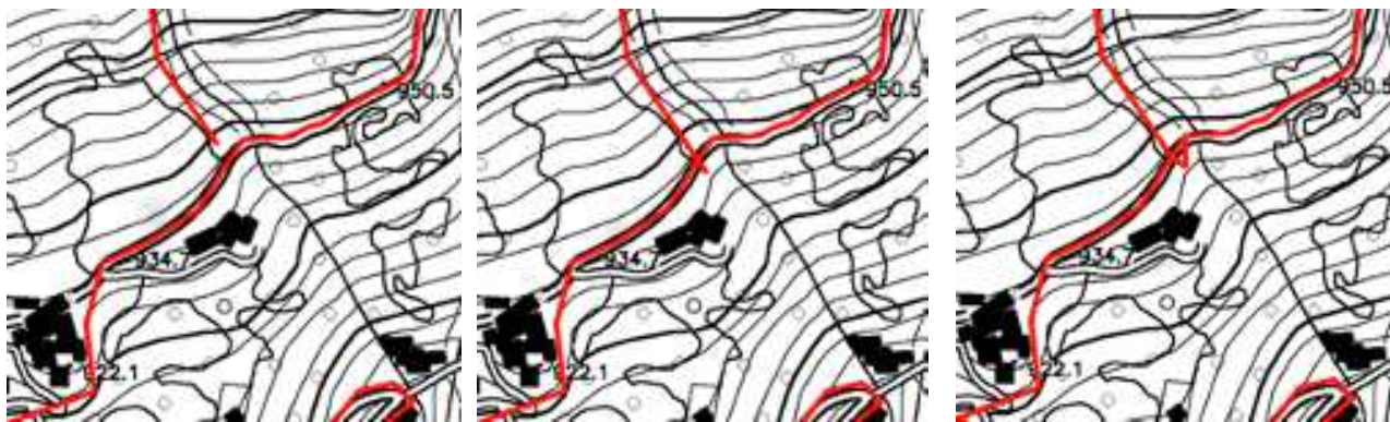
Esempi di possibili errori topologici da evitare nell'elaborazione della traccia rilevata.
