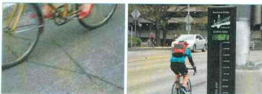
Figura 1 e 2 – Esempi di sensore induttivo per il conteggio dei flussi e display informativo
