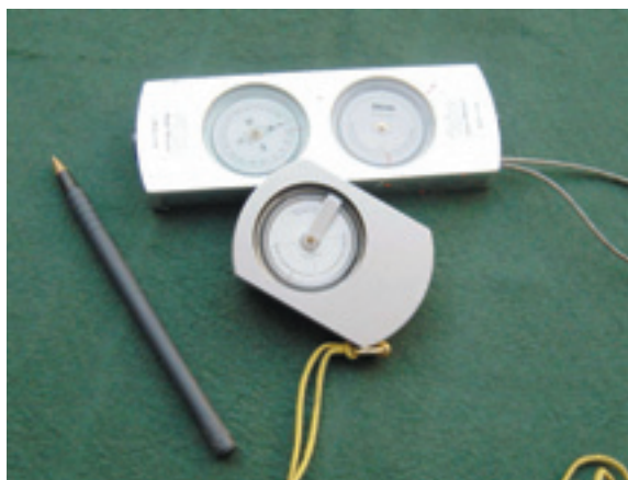
Figura 5.7 - Gli strumenti per il rilievo a mano libera hanno ingombro assai modesto: clisimetro (sotto) e clisimetro-bussola (sopra).
