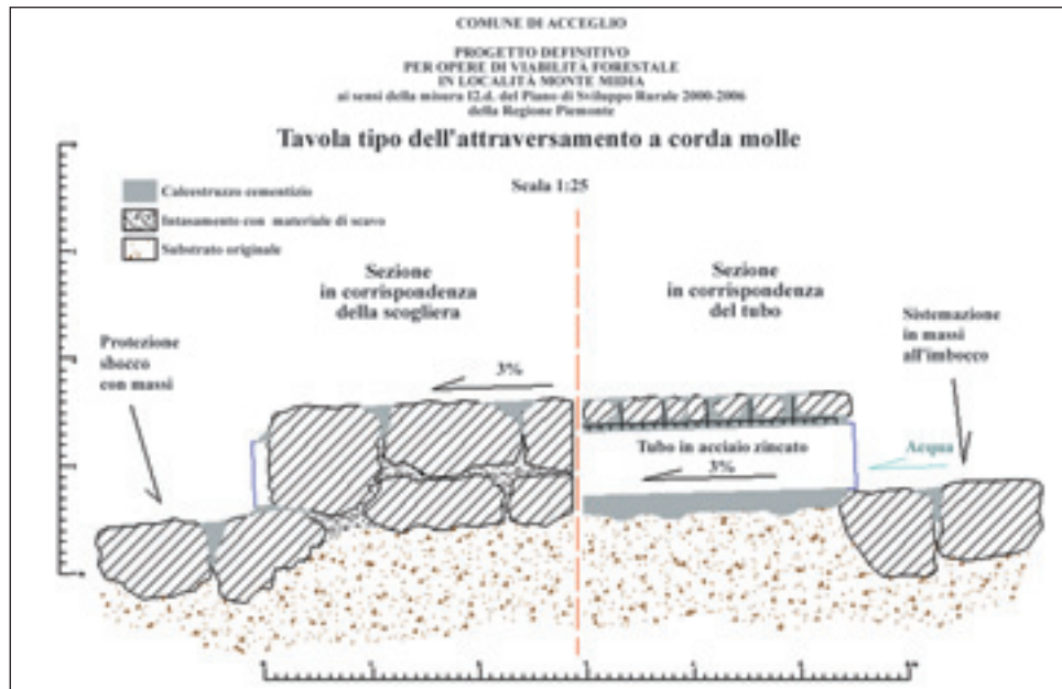
Figura 7.6 - Esempio di sezione tipo per guado a corda molle.
