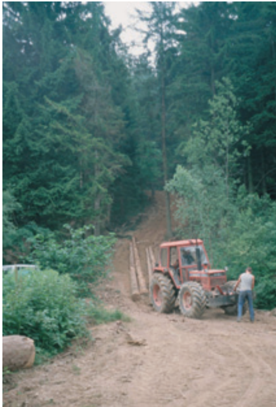
Figura 1.3 - A sx pista di strascico per trattori (Valle Maira-Cn); a dx varco per una linea di gru a cavo forestale (Alta Valle di Susa-To). Le vie di esbosco servono per l'abduzione del legname ma non per l'accesso del personale. Si tratta di varchi nel soprassuolo con pendenze longitudinali di norma superiori al 25%, destinati a richiudersi in breve tempo ultimate le operazioni di utilizzazione.
