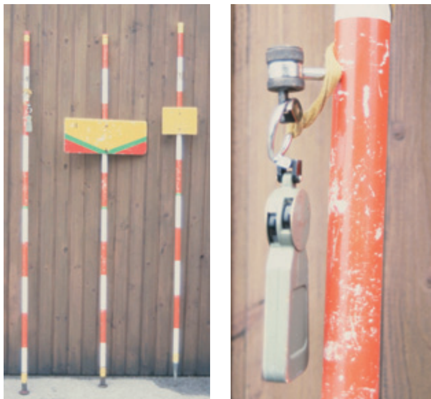
Figura 5.15 - Paline topografiche cui è stata applicata una tavoletta di mira per facilitare il traguardo con strumenti a mano libera (sx) e un supporto per il clisimetro a pendolo (dx).
