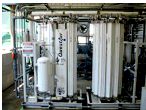
Figura 29 – Impianto PSA, modello M-3200 [Verdesis (2008)]
