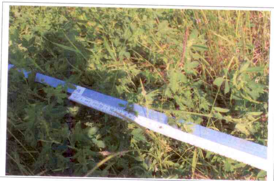
Foto 2. Asta graduata utilizzata per la misura del battente idrico. L'asta graduata è stata immersa nel lago fino al contatto con i depositi del fondo lago.
